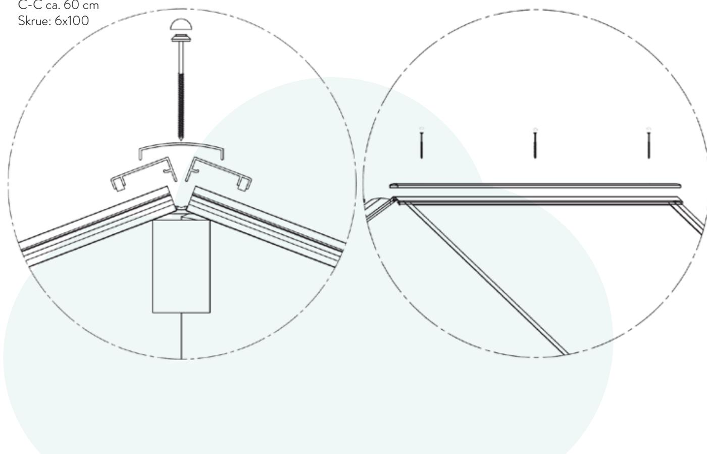
Vindskibord monteres med skruer under avslutningsprofilene
